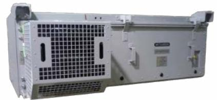
鉄道車両用インバータ装置 気候変動
