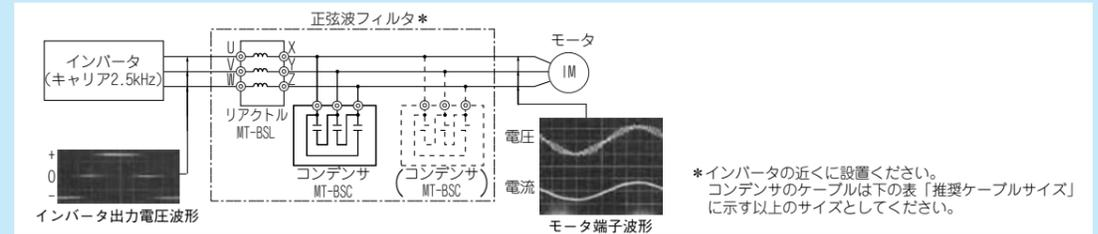
\* インバータの近くに設置ください。コンデンサのケーブルは下の表「推奨ケーブルサイズ」に示す以上のサイズとしてください。
