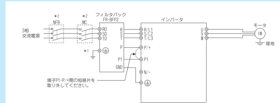
\*1 フィルタパックのGNDケーブルはインバータの接地端子に接続してください。フィルタパックの接地端子で大地接地してください。インバータの接地もフィルタパックを介して大地接地します。
