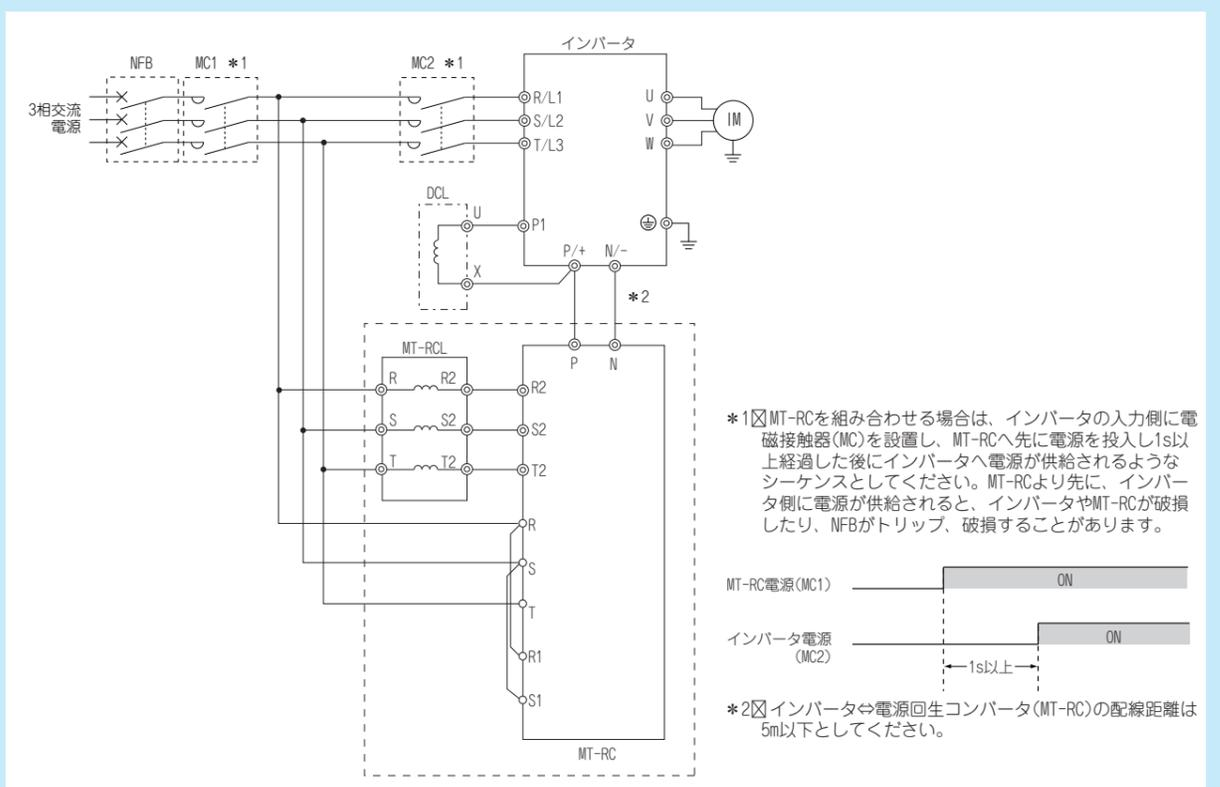
\*1 1 MT-RCを組み合わせる場合は、インバータの入力側に電磁接触器 (MC) を設置し、MT-RCへ先に電源を投入し1s以上経過した後インバータへ電源が供給されるようなシーケンスとしてください。MT-RCより先に、インバータ側に電源が供給されると、インバータやMT-RCが破損したり、NFBがトリップ、破損することがあります。
