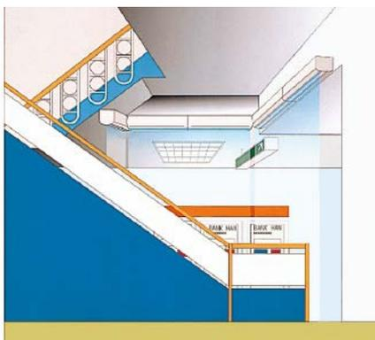
●吹き抜け空間がある場合、冬場の暖気は2階へ流れていきますが、エアーカーテンでその流れを遮断してゾーニングを行うことにより、2階への暖気の流出を防ぎます。
