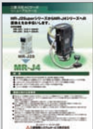
MR-J2S リニューアルツール カタログ X901208-280 既設配線および取付け穴をそのまま利用でき、短時間で置換え可能なリニューアルツールの紹介です。
