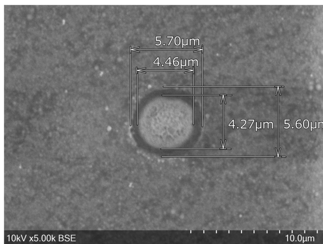
図3: ABFに微細かつ高品位穴あけを目指した例。テーパ度は75%。穴の側面が小さいことがわかる
