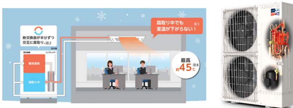
図1 霜取りと暖房運転両立のイメージ（左）と、デュアルオンデフロスト回路イメージ（右）
