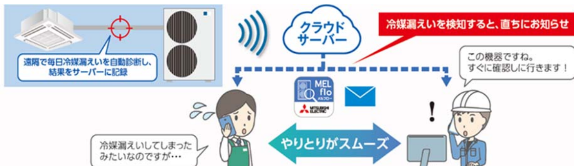
図2 冷媒漏えい検知機能のイメージ
