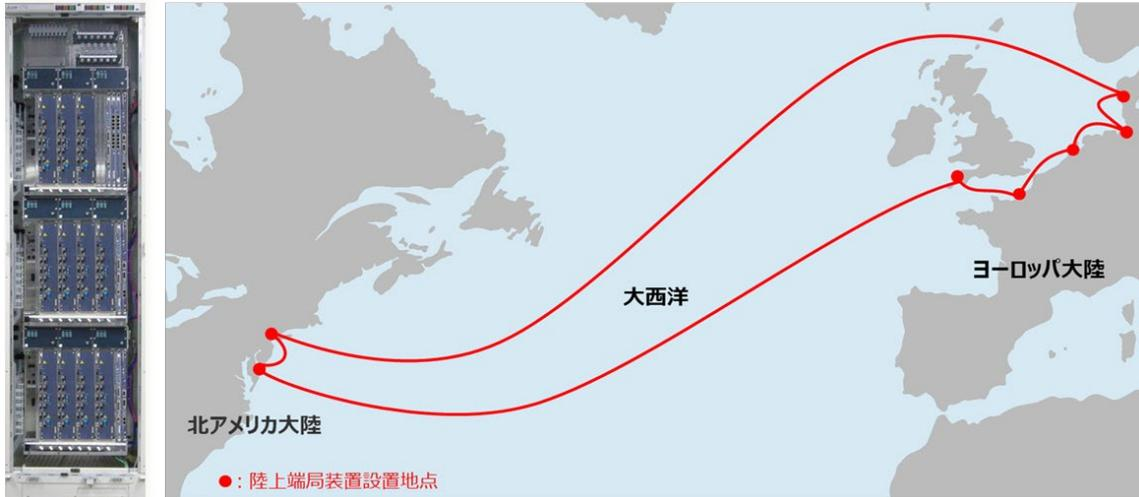
受賞技術を適用した陸上端局装置（左）と大西洋横断海底ケーブルシステム（TAT-14）のネットワーク図（右）
