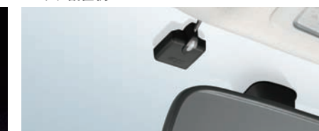
ルームミラー裏のフロントガラスに *アンテナ部をフロントガラスに取付ける際は、ルームミラーの陰で運転者の視界の妨げにならない場所に取付けてください。
