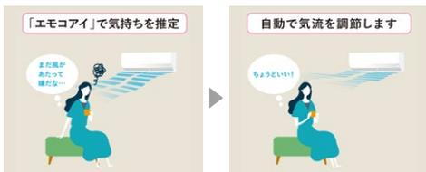
「エモコアイ」が脈から感情を推定し、不快と判断した場合は、風向を自動で調節。温度や気流を制御して、くつろぎやすい空気を目指します。
