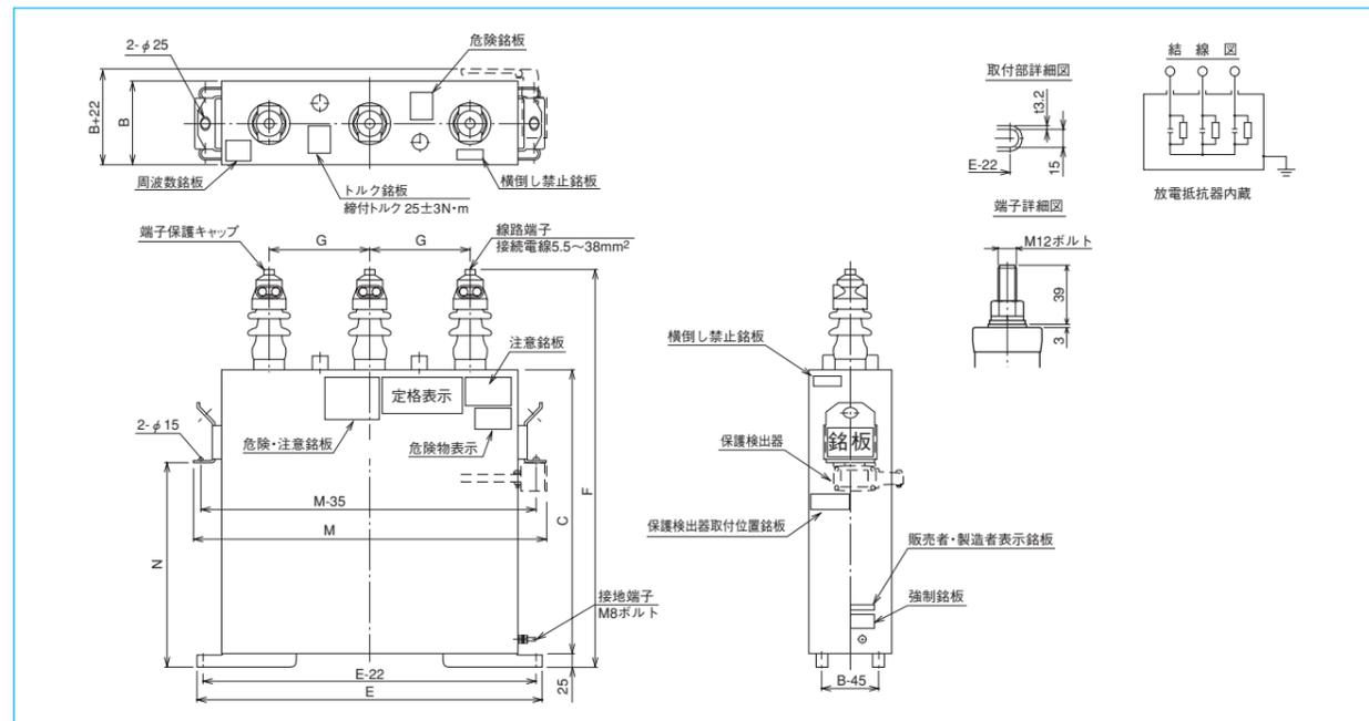
(注) 1. 本コンデンサを2台以上集合される場合は、コンデンサ相互間隔を設備容量150~300kvarで80mm以上、設備容量400~500kvarで100mm以上とってください。
