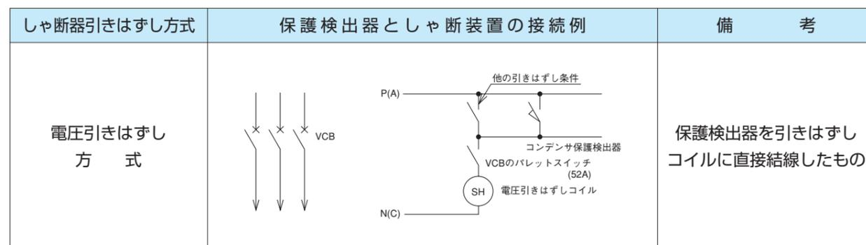
(注) 低圧進相コンデンサ設備、直列リアクトルの保護方式については、32~42ページの個別機器仕様欄を確認ください。
