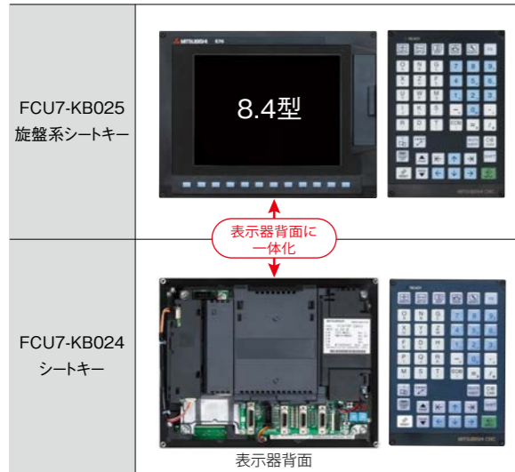
制御ユニットは表示器背面に一体化しています。
