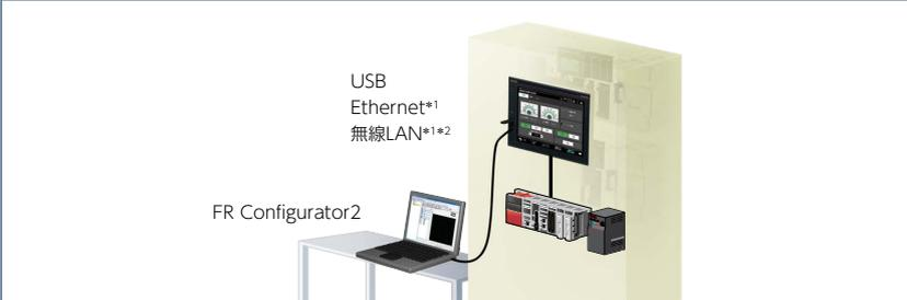
GOTのUSBインターフェイスとパソコンを接続し、GOTを経由してインバータのプログラミングや立上げ、調整作業ができます。制御盤を開けたり、ケーブルを付け替える手間がかかりません。
