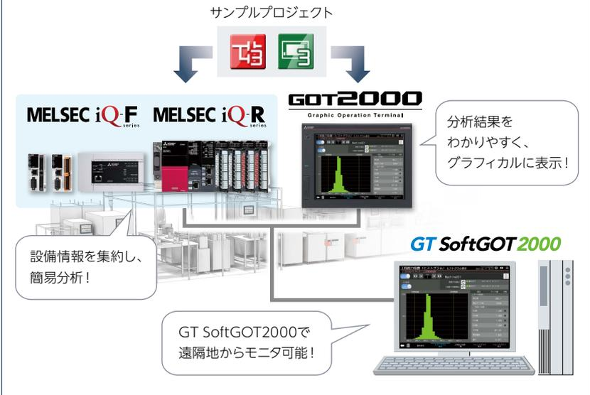
既存設備に統括管理シーケンサ・GOTを追加して、シンプルCPU通信機能などを活用することで、簡単に既存設備の「見える化」、「簡易分析」などの機能を構築可能です。
