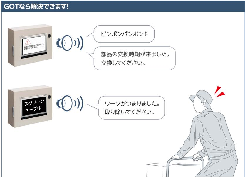
GOTで音声の出力が可能です。音声通知をすることでGOTから離れた作業者にイベントの発生をより確実に伝えることができます。スクリーンセーブ中でも音声通知が可能です。
