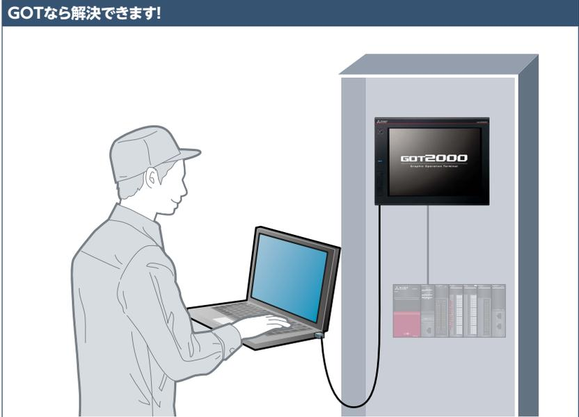
盤を閉じたまま、GOTの前面USBインターフェイスとパソコンを接続し、GOTを経由してFA機器のプログラミングや立上げ、調整作業ができます。
