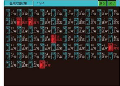
CC-Link IE TSN、CC-Link IEコントローラネットワーク、CC-Link IEフィールドネットワーク、MELSECNET/H、MELSECNET/10のネットワーク状態をモニタし、GOTに表示できます。
