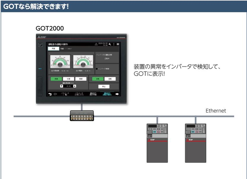
インバータ正常時の出力周波数とトルクの関係をインバータに記憶させて、負荷が正常な状態で運転しているか監視できます。正常範囲から外れた場合にエラー・警告を出力することで装置の異常検出やメンテナンスに活躍します。
