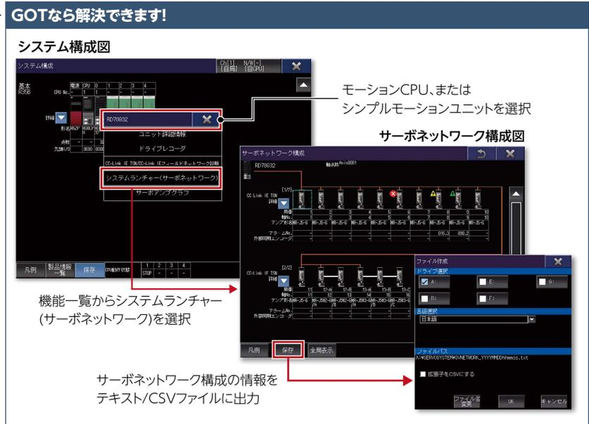
GOTに接続されたサーボアンプの状態をグラフィカルなシステム構成図から確認できます。
