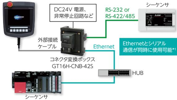
\*1 Ethernetとシリアル通信を同時に使用する場合、マルチチャンネル機能で接続機器設定を行ってください。
