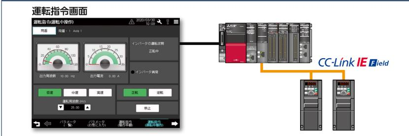
GOTでインバータの運転指令ができます。インバータの出力周波数と出力電流の値をモニタしながら、装置の動きを確認でき、立上げの作業効率が向上します。
