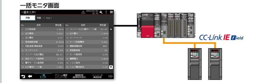
パソコンを準備したり、インバータを直接確認しなくても、GOTでインバータの出力周波数や出力電流、出力電圧などの現在値のモニタができます。
