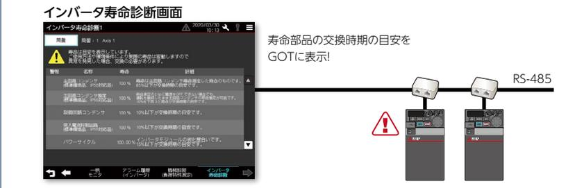
GOTでインバータの有寿命部品(主回路コンデンサや制御回路コンデンサ、冷却ファンなど)の稼働状況をモニタし、交換時期を確認することができます。インバータが故障する前に交換でき、予知保全を実現します。
