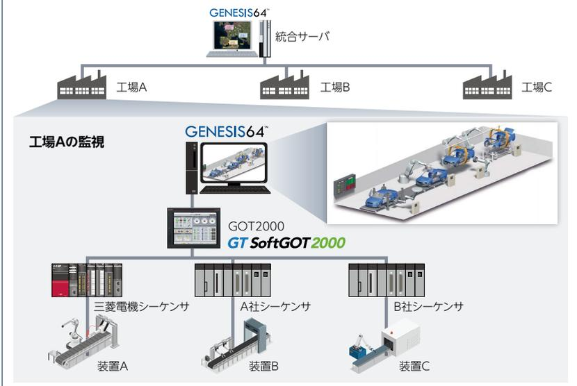
SCADAソフトウェアGENESIS64™は、現場に設置したGOT2000またはGT SoftGOT2000を経由することで、装置ごとの機器の情報を収集できます。各工場の装置の運用状況を監視するだけでなく、高度な予防保全、予兆保全に活用できます。
