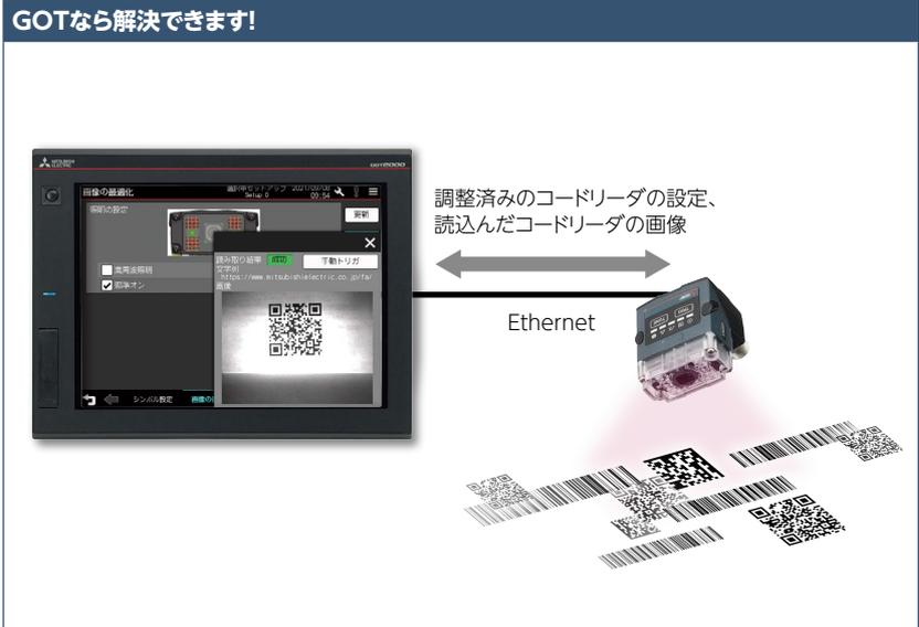
段取り替え時や動作状態の確認など、パソコンレスでコードリーダーの設定変更・モニタがしたい。
