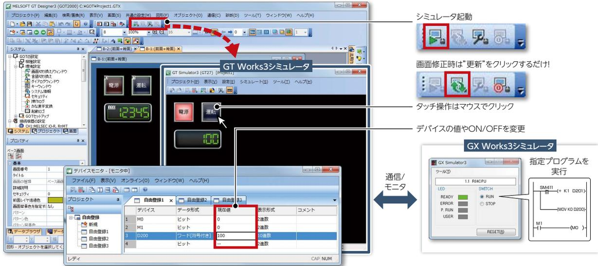
手順:[ツール(T)] → [シミュレータ(A)] → [起動(A)]
