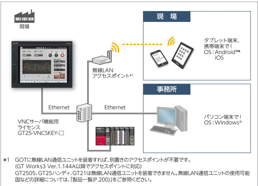
\*1 GOTに無線LAN通信ユニットを装着すれば、別置きのアクセスポイントが不要です。(GT Works3 Ver.1.144A以降でアクセスポイントに対応)
