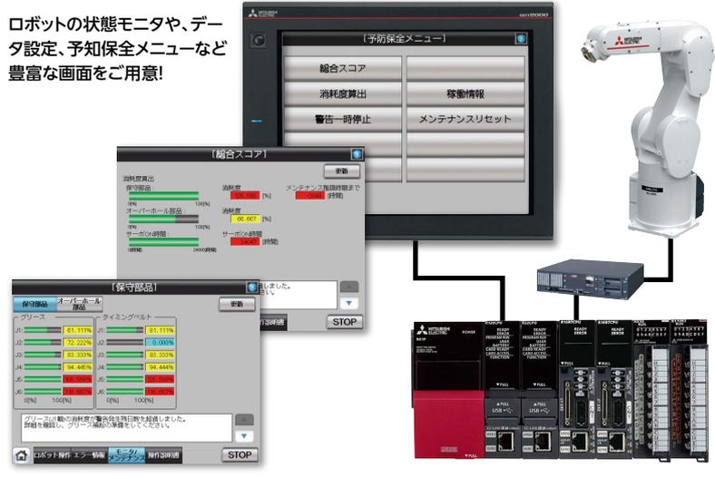
GOTからロボットの操作や状態モニタができます。GOTからロボットの起動・停止、エラー情報のモニタなどを容易にできます。
