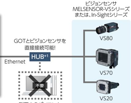
ビジョンセンサ用のモニタを設置せずに、GOTで直接ビジョンセンサを簡単にモニタ・操作したい…。
