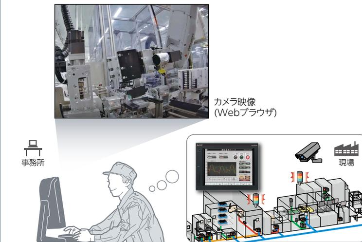
GOT Mobile機能を使用して、現場の様子を映像で確認できます。パソコンやタブレットなどのWebブラウザが使用できるため、ネットワークカメラのライブ映像や録画ファイルを簡単に確認できます。
