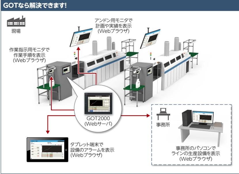
iQ Monozukuri アンドンはGOT2000+汎用Webブラウザで簡単に実現できる簡易アンドンパッケージです。生産設備から得られる情報を、GOT2000を通してアンドン用モニタなどに表示することで、現場の情報を共有し、見える化します。
