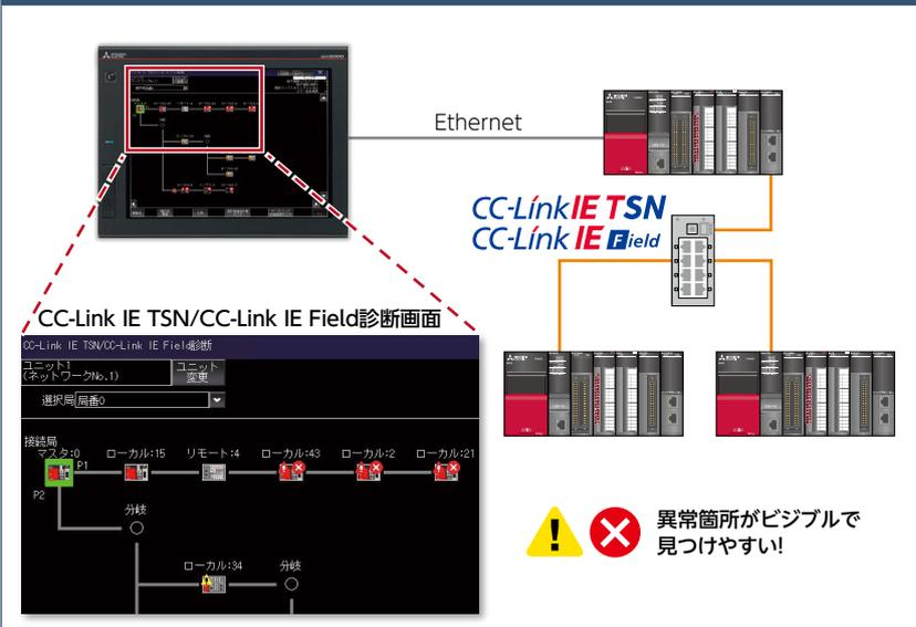
大規模システムでネットワーク構成が複雑でも、ネットワーク全体の状況をビジュアルに確認できるため、回線トラブル、ユニットの異常をすぐに発見できます。
