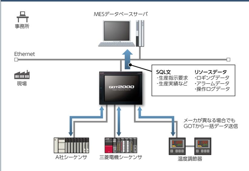
GOTは、パソコンレス・プログラムレスでMESデータベースサーバと通信し、生産指示要求や生産実績などのデータを送信できます。また、アラーム履歴やロギングデータなどのリソースデータをデータベースに蓄積しておくことで、トレーサビリティの強化に役立ちます。
