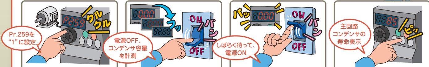
モータが接続されて停止中であることを確認した後、Pr.259に“1”を設定します。
