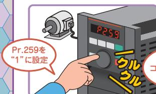
モータが接続されて停止中であることを確認した後、Pr.259に"1"を設定します。
