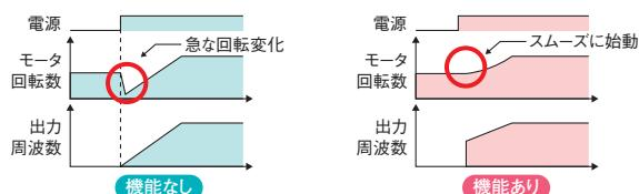
始動時の加速時間を調整するパラメータ(Pr.611)や、ファンの回転方向を検出するパラメータ(Pr.299)などがあるんだ。
