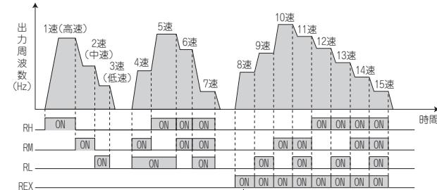
\* Pr.232 多段速設定(8速) = "9999" 設定時、RH、RM、RLをOFF、REXをONとするとPr.6の周波数で動作します。
