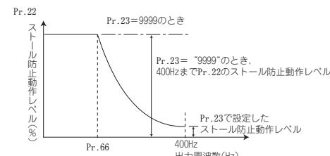
●負荷のイナーシャが大きい用途でストール防止動作中に過電圧保護機能（E.OV□）が動作する場合は、Pr.154 = "11"と設定してください。ただし、ストール防止動作中に始動信号（STF/STR）をOFFしたり、周波数指令を変化させた時に加減速の開始が遅れることがあります。
