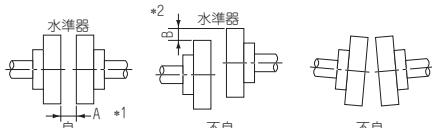
\*1 A寸法がどの位置をスキマゲージで測っても同一寸法となるようにする(Aの幅不同3/100mm以下)。
