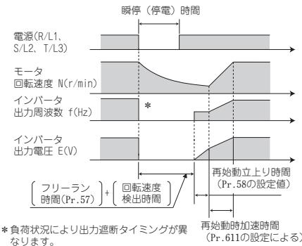
●Pr.30 によってMRS(X10)信号をON→OFFした後の再始動動作を選択することができます。高力率コンバータ(FR-HC2)を使用して、瞬停再始動を選択している場合に使用します。(32ページ参照)
