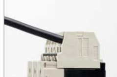
接続完了確認 ※カラー部が端子面より奥まで差し込まれていれば接続完了
