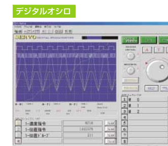
●本物のオシロスコープを使用せず、モーシヨンシステムの時系列の動作状況を収集/確認が可能
