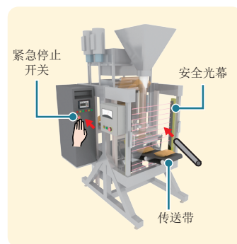
8 确认安全控制电路的动作
