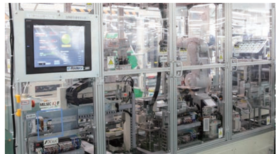
当社産業用ロボット MELFA2 台が分業でユニット組立てを行っている
