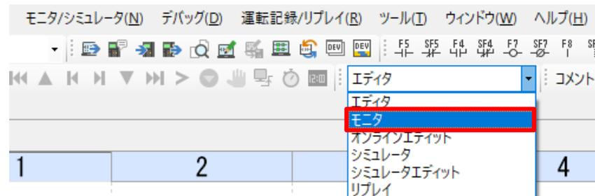
4. [モニタ/シミュレータ]→[登録モニタウィンドウ]で登録モニタウィンドウを表示後，読出し/書込みするデバイスを登録します。
