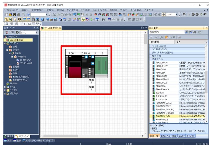
3. ユニット構成図の「RJ71EN71」をダブルクリックし、[はい]ボタンをクリックしてパラメータを確定します。
