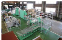
発泡角容器検査箱詰ライン
