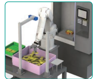
大型パレットからのピッキング (固定カメラ)
