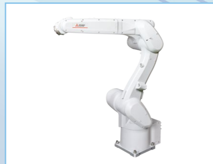
RV-12CRL 可搬質量:12kg 最大リーチ半径:1504mm
