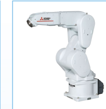
RV-20FR-D/Q/R 可搬質量:20kg 最大リーチ半径:1094mm
