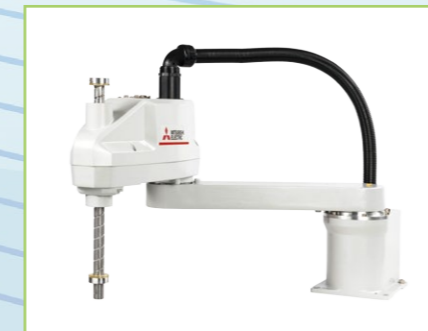
RH-6CRH7020-D 可搬質量:6kg 最大リーチ半径:700mm
