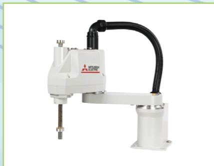
RH-3CRH4018-D 可搬質量:3kg 最大リーチ半径:400mm
