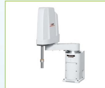
RH-6FRH45**D/Q/R 可搬質量:6kg 最大リーチ半径:450mm
