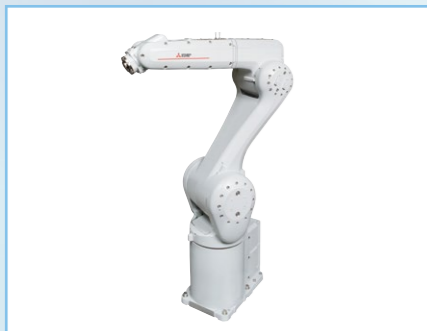
RV-8CRL-D 可搬質量:8kg 最大リーチ半径:931mm
