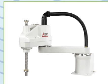
RH-6CRH6020-D 可搬質量:6kg 最大リーチ半径:600mm
