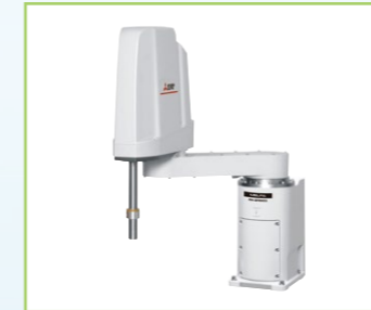
RH-6FRH55**D/Q/R 可搬質量:6kg 最大リーチ半径:550mm
