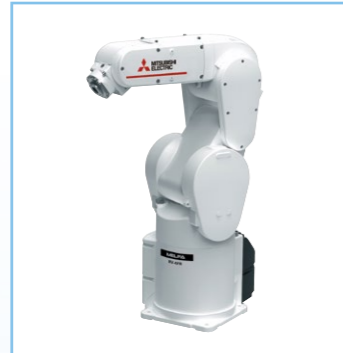
RV-4FR-D/Q/R 可搬質量:4kg 最大リーチ半径:515mm
