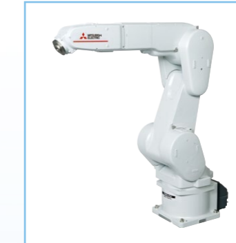
RV-13FRL-D/Q/R 可搬質量:13kg 最大リーチ半径:1388mm
