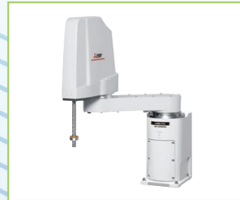
RH-3FRH55**D/Q/R 可搬質量:3kg 最大リーチ半径:550mm
