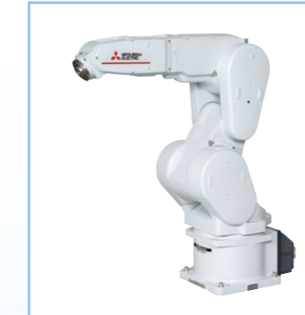
RV-13FR-D/Q/R 可搬質量:13kg 最大リーチ半径:1094mm
