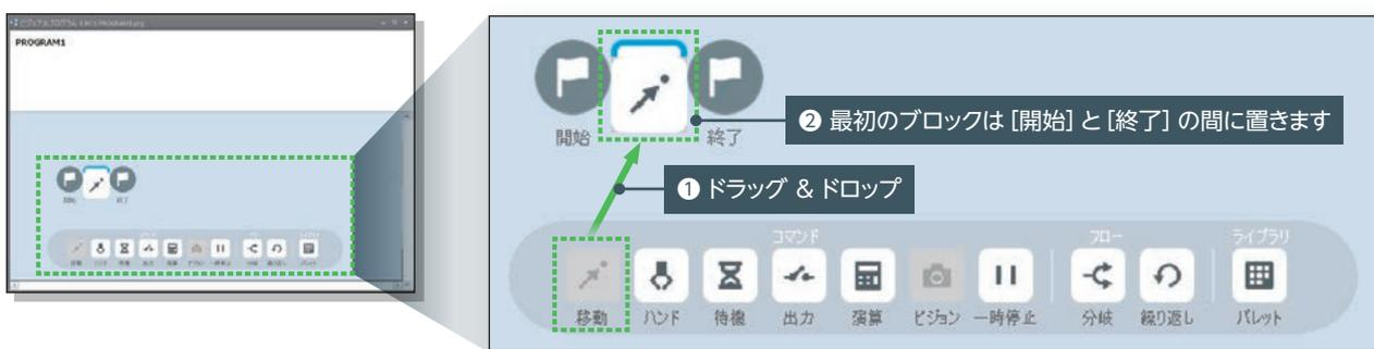
[ブロックパネル] からブロックをドラッグ&ドロップして、動作させる順番に [プログラムエリア] に配置します。
