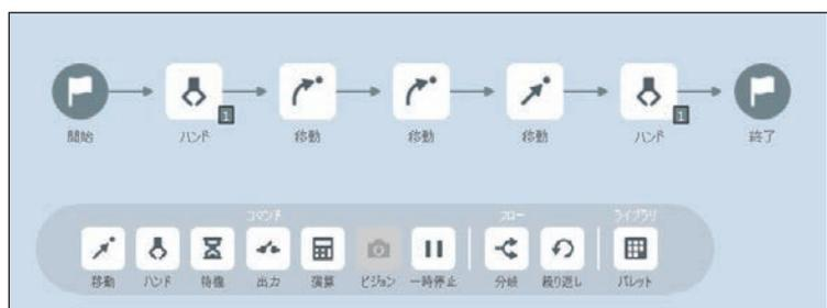
ロボットの動きに合わせてプログラムブロックを並べるだけで、簡単に設定できます。
