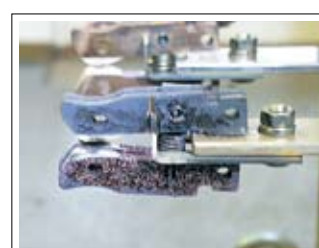
ジャンクション部の過熱・溶損
