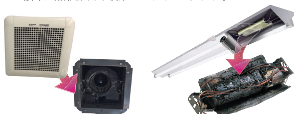
外観は問題なくても、内部は汚れや部品が劣化
