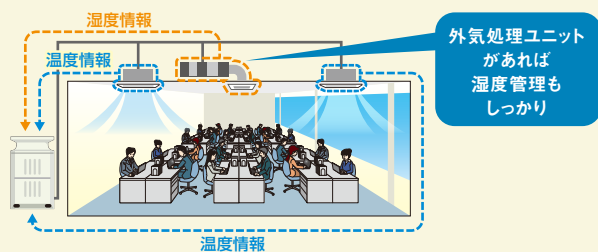
潜熱スマート除/加湿空調システム
