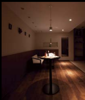
通路部(ユニバーサルダウンライト) クラス75(ハロゲンランプ50W相当) 配光:15° 電球色(3000K)
