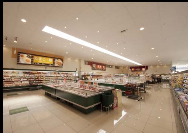
昼間はトップライトによって照度を確保。LED照明器具は調光制御により消費電力を抑えた運転をしています。
