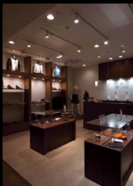
壁面部 (拡散光ダウンライト) クラス60 (白熱電球60W相当) カウンター背面: 昼白色 (5000K) 壁面棚: 電球色 (3000K)
