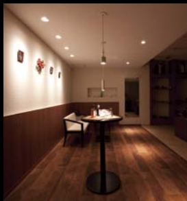
壁面部(ユニバーサルダウンライト) クラス75(ハロゲンランプ50W相当) 配光:20° 電球色(3000K)
