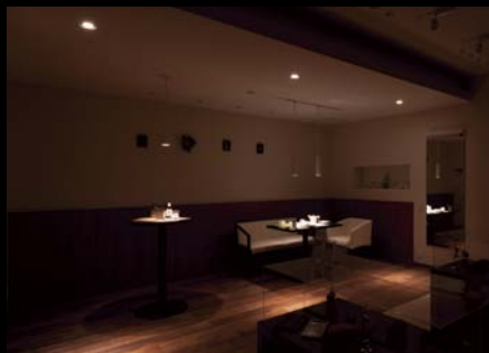
通路部(ユニバーサルダウンライト) クラス75(ハロゲンランプ50W相当) 配光:15° 電球色(3000K)
