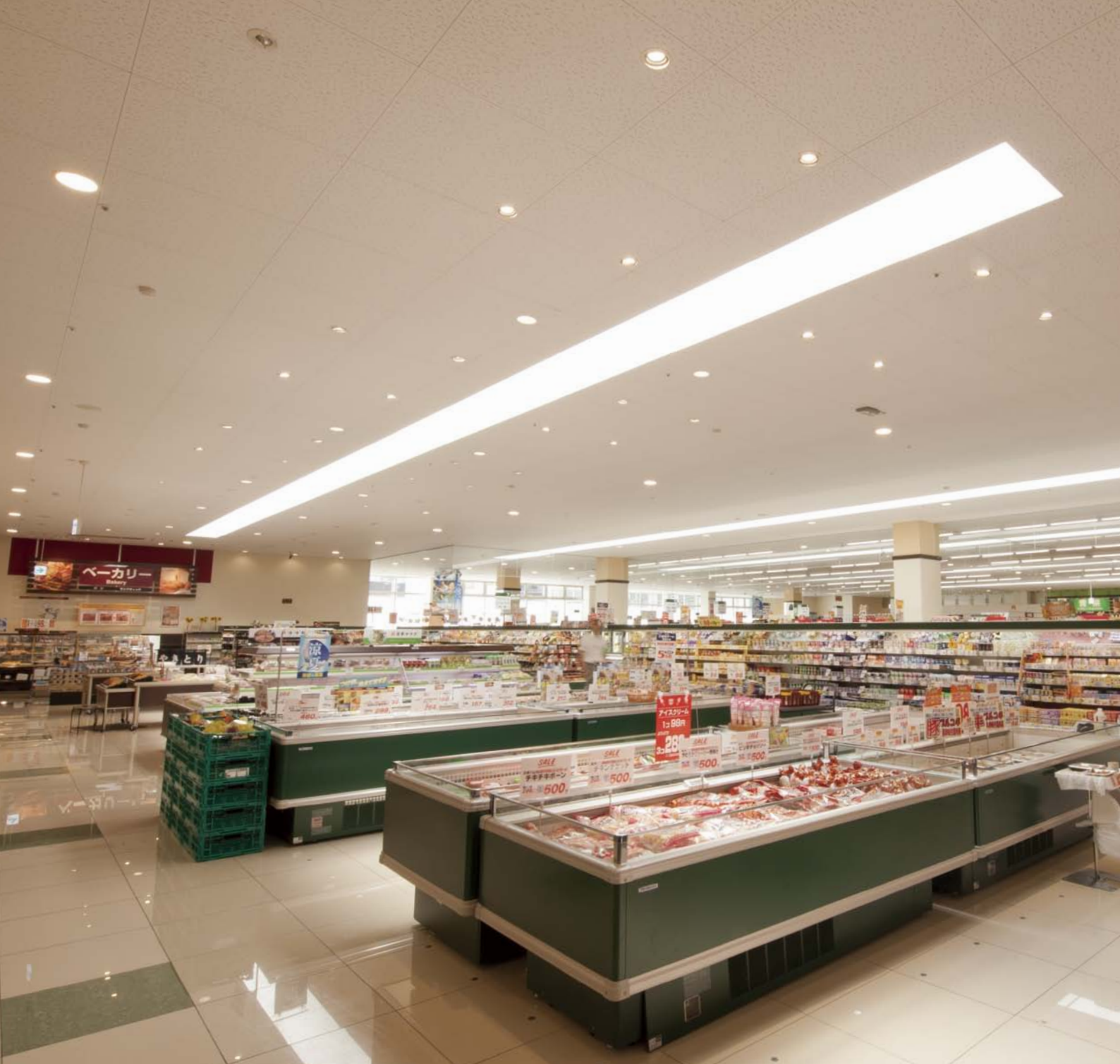
昼間はトップライトによって照度を確保。LED照明器具は調光制御により消費電力を抑えた運転をしています。
