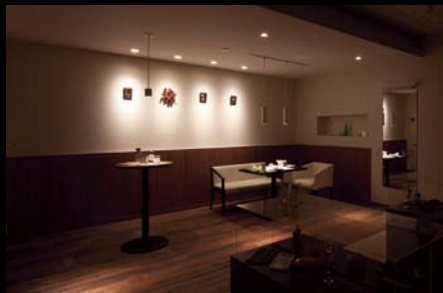
壁面部(ユニバーサルダウンライト) クラス75(ハロゲンランプ50W相当) 配光:20° 電球色(3000K)
