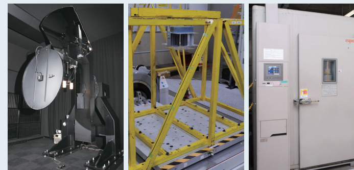
配光測定試験:光の広がり・強さを計測します 耐振試験:上下・左右に振動させ、耐振性を検証します 環境試験:一定の温度を保つ恒温槽でさまざまな温度環境点灯試験を実施します
