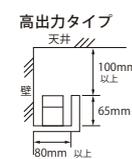
コーニス照明 (壁面に光を反射)
