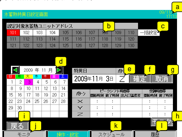
(o)氷蓄熱特異日設定画面(インターフェース基板ソフトウェアVer.3.00以降～、GOTソフトウェアVer.2.00以降～対応)
