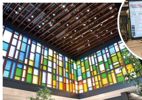
▲駅からつながる新館北西側のエントランス。上部に外調機からの吹出口を設置
