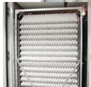
▲25℃・湿度55%のセッター室で18~19日間加温。このあと25℃のハッチャー室で2~3日間加温され、ヒナになる
