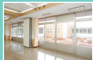
空調機も天井内に納められ、床面の有効利用に貢献している。
