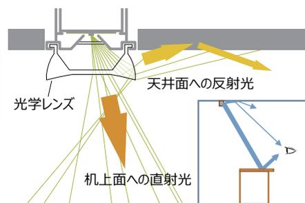
レンズ制御とLED光源により机上面、天井面に光を適切にコントロール。空間全体の明るさ感を高めることで、消費電力を削減を図ります。
