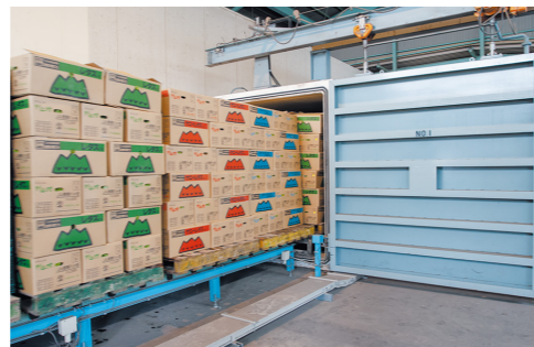
▲レタスなどの高原野菜は真空予冷してから出荷することで朝採りの鮮度を保つことができる。減圧することで野菜から蒸発潜熱を奪い、冷却効果を得る真空予冷は、冷却時間が短く、水切り(余分な水分をとばして鮮度を維持する)効果もある
