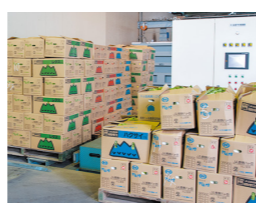
▲パレットの上で待機中のレタスとハクサイ。右奥は真空予冷制御盤
