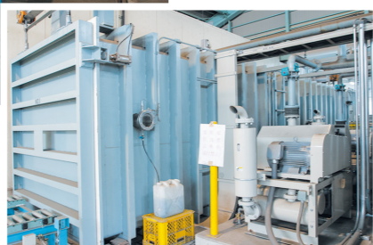
▲真空冷却槽は角型(W2,100×H2,200mm)で容量9,380リットル。真空ポンプは空冷ドライタイプ
