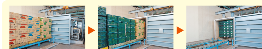
▲コンベアで冷却槽へ。箱詰め、またはコンテナ用ケースのままでも真空予冷の特長
