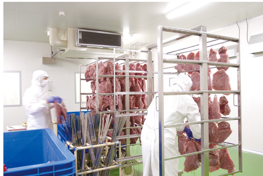
▲肉を燻して生ハムに加工するための下準備。冷却機能付きの産業用除湿機が稼働中
