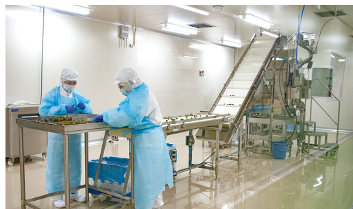
▲オリーブの小分け工程。クリーンルームの空調は設備用パッケージエア コン(吹出ダクト接続)
