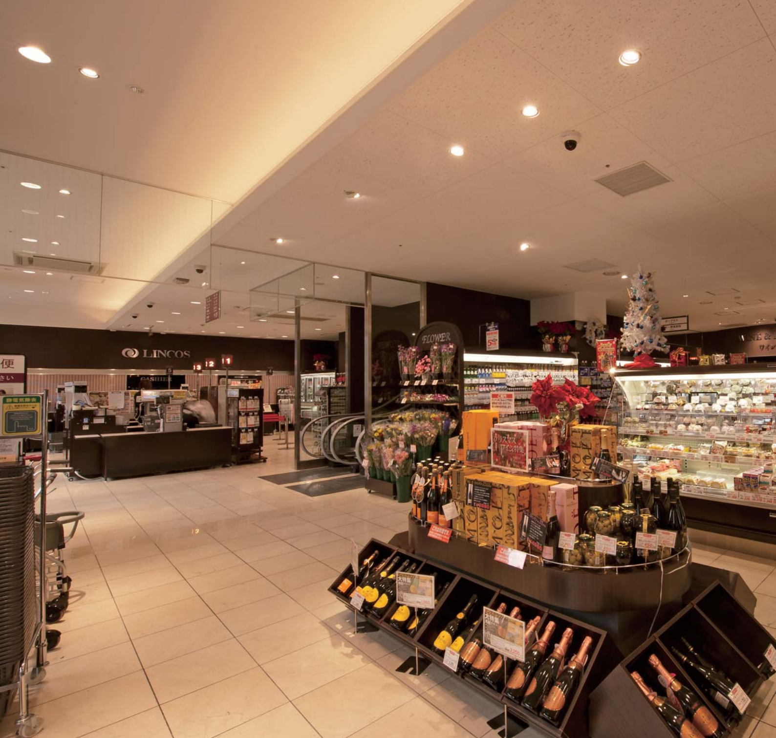
落ち着いた内装に相応しく、照度を抑えた照明計画。メリハリの効いた照明計画とタイマー制御により、快適性と省エネを両立しています。
