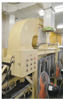
▲作業エリアのスポット空調と飴成型時の冷却工程に使用
