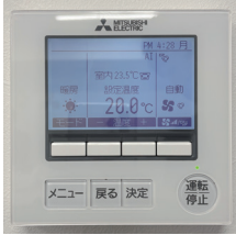
▲PAR-46MA FF式暖房機との併用ですが、設定温度20℃で十分あたたかいです。部屋の4面のうち2面に窓がある点、出入口付近に外気が流入しやすい点から、「ムラ無し」モードに設定しています。
