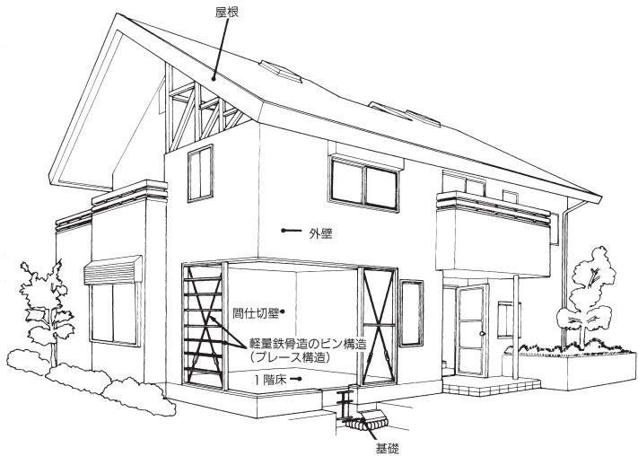
図 5-1 鉄筋系プレハブの構造例
