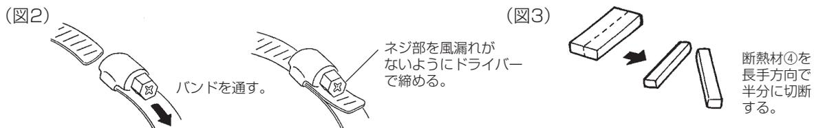
**注意** 断熱材④は圧縮しますと断熱効果が低下しますので、断熱材④を圧縮しないように巻き付けてください。
