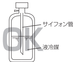
【サイフォン管付ポンベの場合（立てたまま冷媒を充填できる）】
