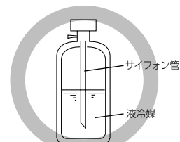
【サイフォン管付きポンベの場合(立てたまま液冷媒を充てんできる)】
