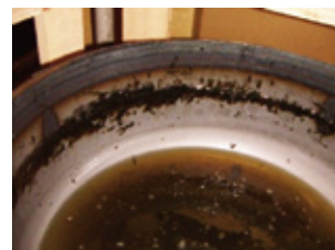
容器壁面に付着したスラッジの例
