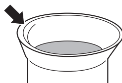
バリ取り不足による段差
