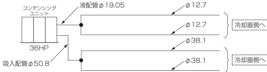
分岐配管の断面積がコンデンシングユニット出口配管の断面積になるべく近くなるように選定します。
