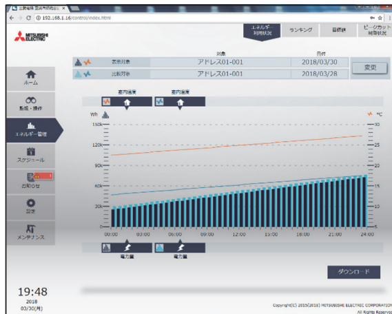
日単位の室内ユニットグループ別電力量表示例
