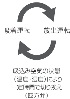
〈図6〉ハイブリッド式除湿機概要図
